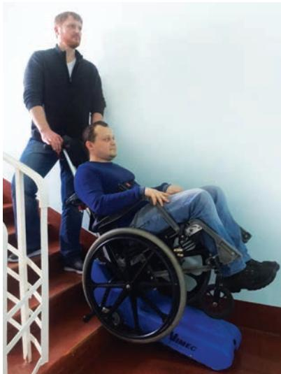
Если в здании нет лифта или не установлен стационарный подъемник, в большинстве случаев оптимальным решением является мобильный лестничный подъемник.
